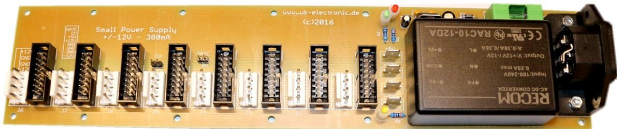
Für kleine Eigenbau-Anwendungen, bei denen bis zu 8 Module eines analogen Modulsystems mit maximal 380 mA Gesamt-Stromaufnahme betrieben werden sollen, ist die Mini PSU (Power supply unit) mit Busplatine gedacht. Die PSU besteht aus einer einfachen Stromversorgung (+12V/max. 380mA, -12V/max. 380mA) und einer damit verbundenen Busplatine mit 8 Steckplätzen für A-100 kompatible System oder MTOM-Systeme.
